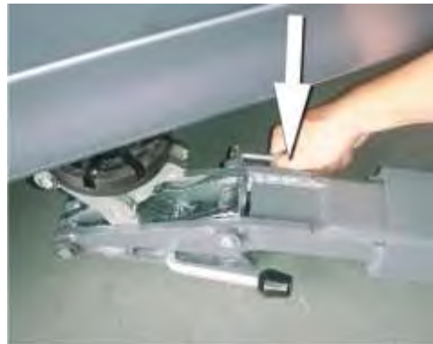
Figura 3: Para desenganchar los platos de elevación se deberá presionar la palanca posterior.
