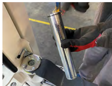
Bullone con anello di sicurezza superiore
