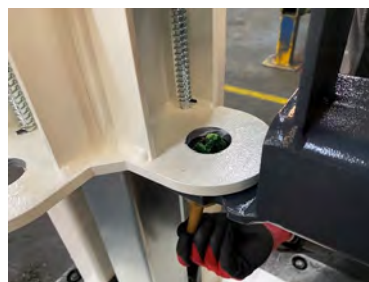
Ingrassare il foro inferiore
