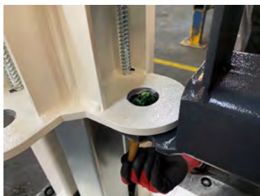
Graisser le trou inférieur
