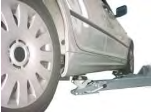
Bild 1: Tragteller unter den vom Fahrzeughersteller geforderten Aufnahmepunkten positionieren
