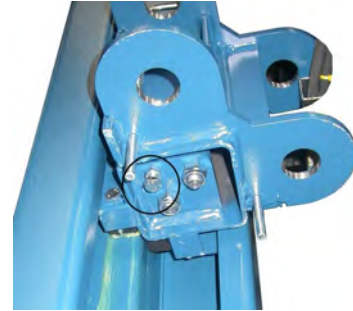
Position der Stellschraube
