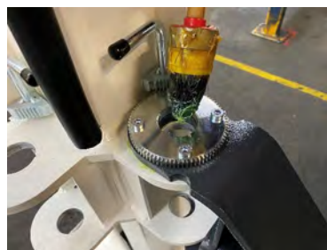
Ingrassare il foro superiore
