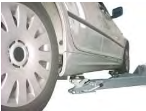
Figure 1 : Positionner des plateaux porteurs sous les points de levage requis par le constructeur du véhicule.
