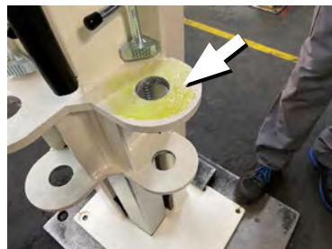
Ingrassare il braccio portante con un grasso multiuso privo di acidi
