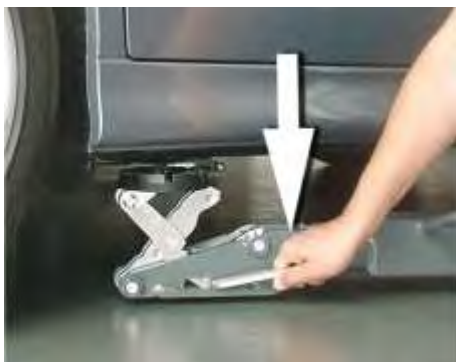
Figura 2: Dado el caso, aplicar los platos portantes en los puntos de elevación presionando la palanca.
