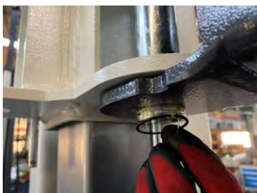
Colocar el anillo de seguridad inferior
