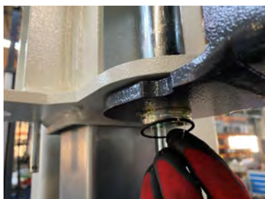
Mettre le circlip en bas
