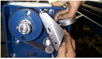
Figure 17 : Positionner l'appareil de mesure sur la courroie
