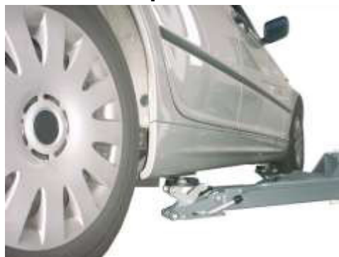
Immagine 1: Posizionare i piattini portanti solo sotto i punti di sollevamento autorizzati dal produttore.
