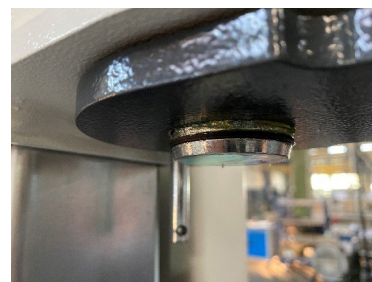
Untere Sicherung des Tragarmbolzens
