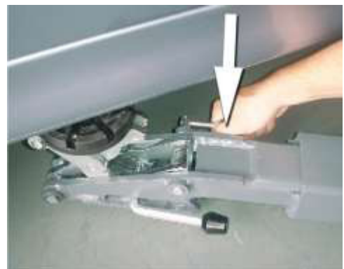
Bild 3: Um die Aufnahmeteller zu entriegeln muss der hintere Hebel gedrückt werden.
