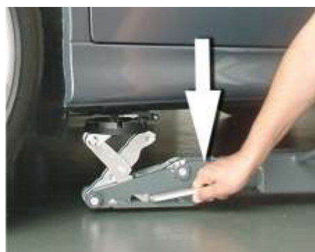
Immagine 2: Eventualmente applicare i piatti portanti premendo la leva sui punti di alloggiamento.
