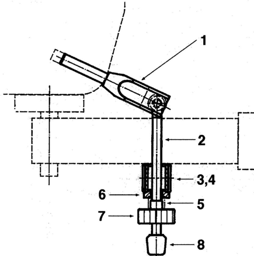
Sicherheitsaufnahme zum Einstecken in die Wagenheberaufnahmen mit Spannelement und Verbindungsrohr
