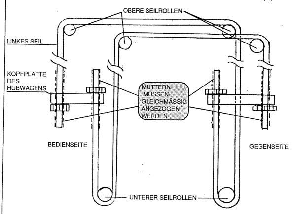
Hubwagens anschlägt. Nehmen Sie das gleiche Seil an der Gegenseite und führen Sie es herunter durch den Hubwagen. Dann, ohne es über die Seilrolle zu legen, wieder in dem Hubwagen hochführen und durch die linke Bohrung führen. Ziehen Sie dann die selbstsichernde Mutter 2-3 Umdrehungen an.
