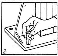
3. Die Dübelmutter ist jetzt mit dem Drehmoment M=80 Nm anzuziehen, die Hülse spreizt sich zylindrisch und bricht dabei an den Sollbruchstellen auf. Danach ist die überstehende Gewindestange des Dübels entsprechend zu kürzen.
