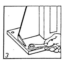
Achtung: Nur Dübel, die sich mit dem vorgeschriebenen Moment anziehen lassen, sind geeignet, die nötige Last zuverlässig zu übertragen und die Sicherheit des Hebezeugs zu gewährleisten.
